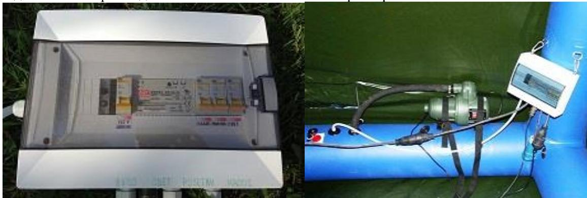
**Компрессор высокого давления** Bravo 220/2000 предназначен для накачки каркаса и регулирования давления в нём. ( в комплекте)
